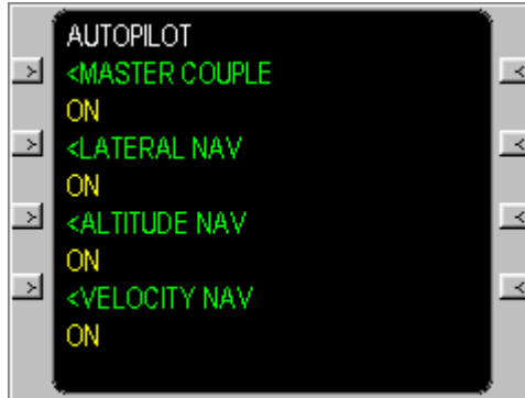
Resim 3.43 : FMS otomatik pilot ekranı
