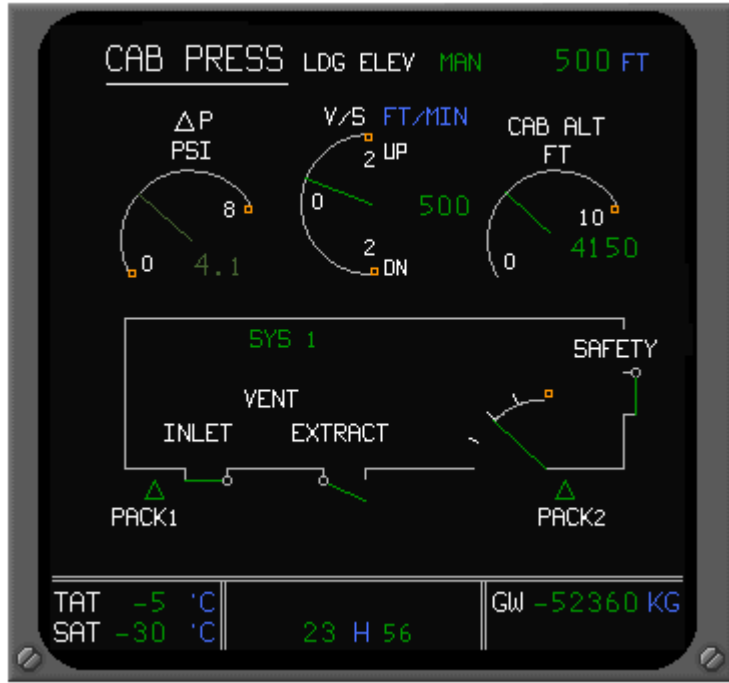
Resim 3.10: Press tuşuna basıldığında sistem ekranı
