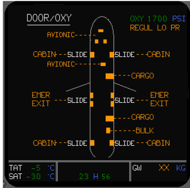
Resim 3.22 : Door tuşuna basıldığında sistem ekranı
