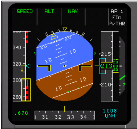
Resim 3.33 : Airspeed limits ekranı
