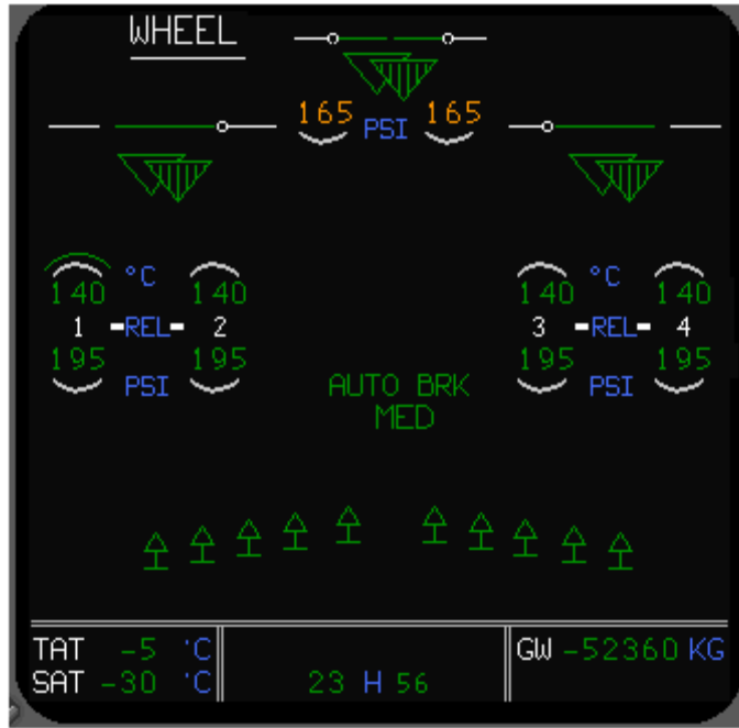
Resim 3.24 : Wheel tuşuna basıldığında sistem ekranı
