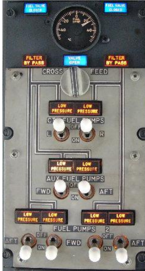
Resim 6.3: 737-Classic-4 -Tank Fuel Panel(737- yakıt tankı gösterge paneli)
