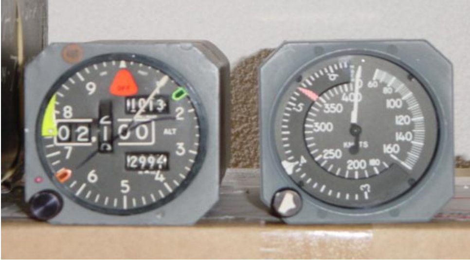
Resim 3.2: Diğer tip uçaklarda rastlanan pnömatik göstergeler
