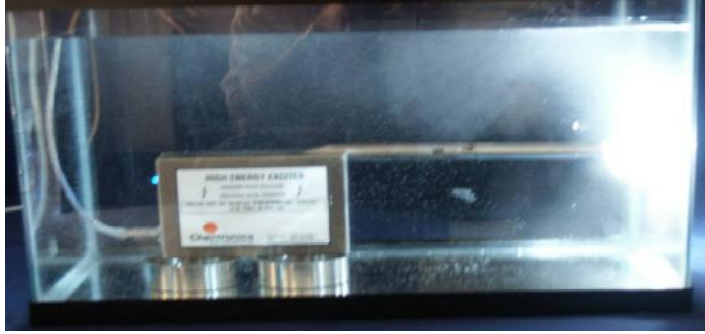
Resim 1.2: Ateşleme sisteminin suda çalışması
