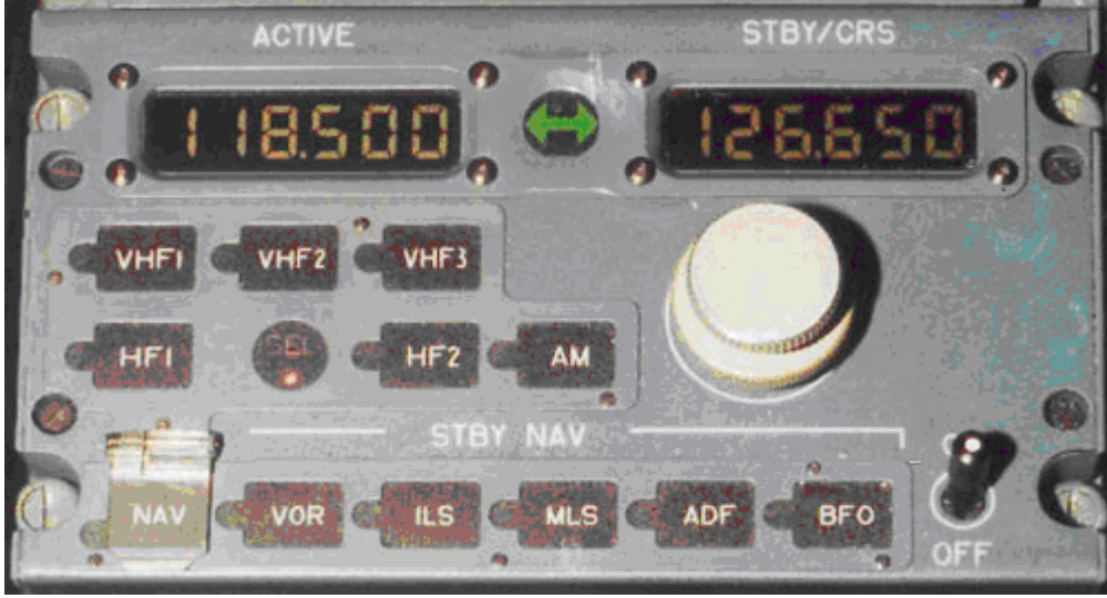
Resim 5.2: Radyo kontrol paneli
