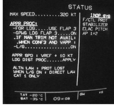
Şekil 2.1: Kokpitte CRT monitör görüntüsü
