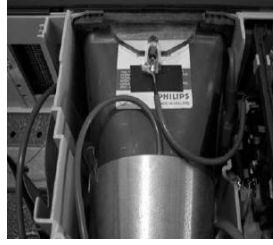
Şekil 2.2: CRT monitör arka kısım görüntüsü
