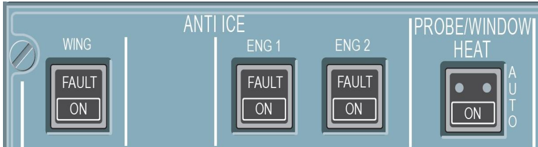
Resim 4.32: Motor ve kanat anti-ice kontrol paneli görüntüsü
