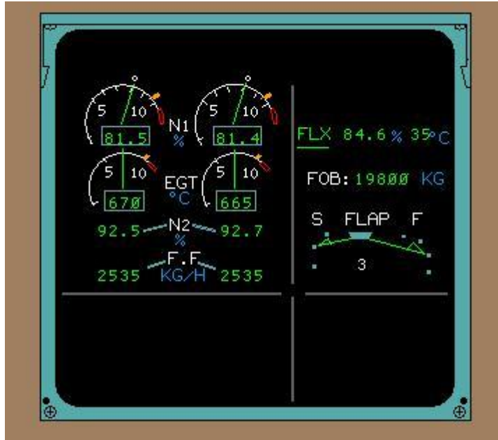
Resim 4.8: Motor uyarı göstergesi üst kısım verileri
