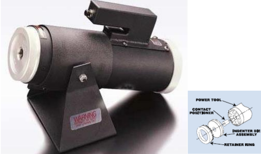
Resim 2.2: Pnömatik çalışmalı bir sıkıştırma aleti
