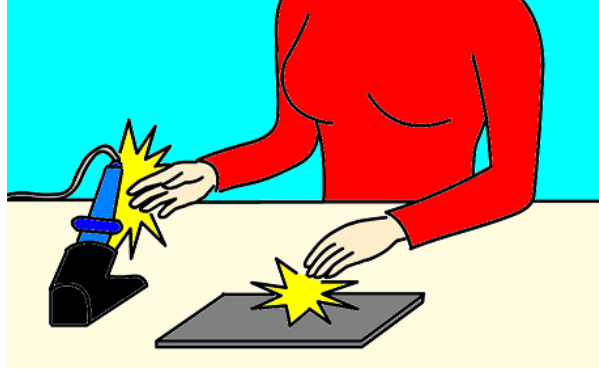
Şekil 1.2: Yükün çalışma ortamında boşalması
