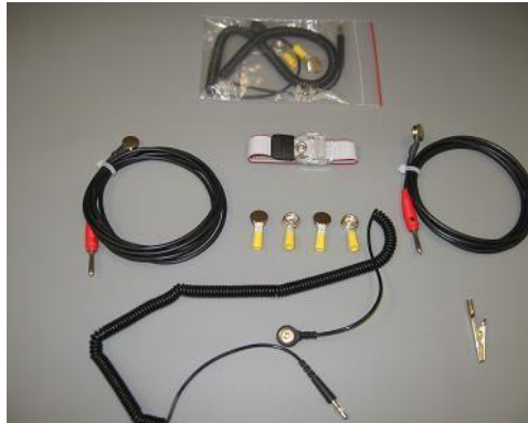
Resim 1.6: ESD bileklik ve bağlantı uçları ve topraklama kabloları
