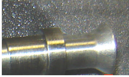
Resim 4.14: Boru ağız (havşa) açılmış
