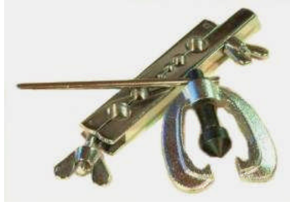
Resim 4.15: Havşa açma (flaring) aparatı ve boru bağlama aparatı
