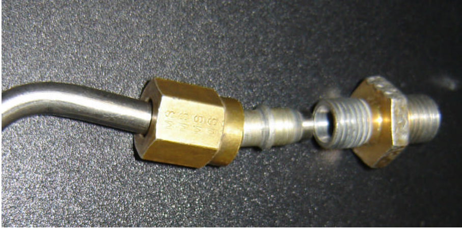
Resim 4.4: MS birleştirme ve nippel
