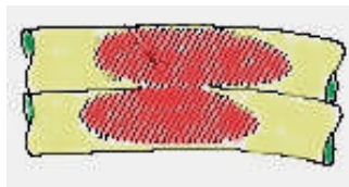
Şekil 5.31: Kablonun bükülerek kontrolü
