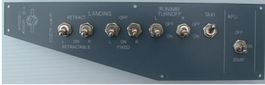
Resim 3.3: Dış aydınlatma kontrol paneli
