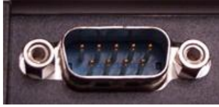
Resim 1.4: Seri portlarda kullanılan DB-9 konnektörü
