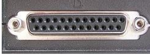
Resim 1.3: Paralel portlarda kullanılan DB-25 konnektörü
