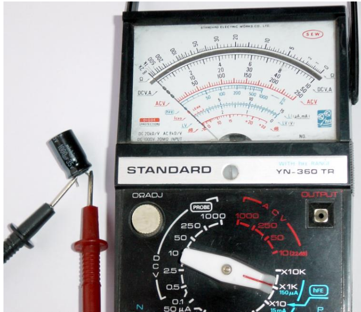
Resim 4.1: Analog ölçü aleti ile kondansatör sağlamlık testi
