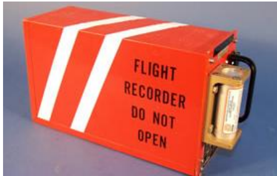
Resim 9.1: CVR gerçek görünümü
