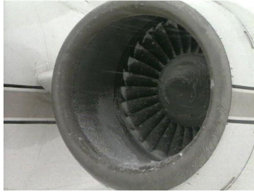
Resim 1.1: Buzlanma meydana gelmiş bir motorda hava giriş kısmı
