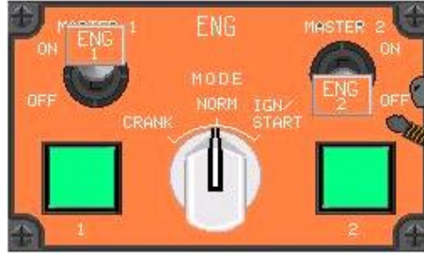
Şekil 4.16: Engine master switch pozisyonu
