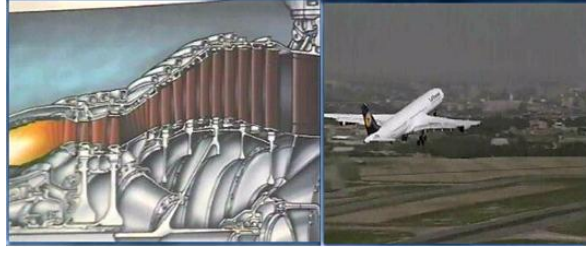
Şekil 4.13: Yanma odasından türbine sıcak hava akışı ve take off'ta maksimum tip klerans
