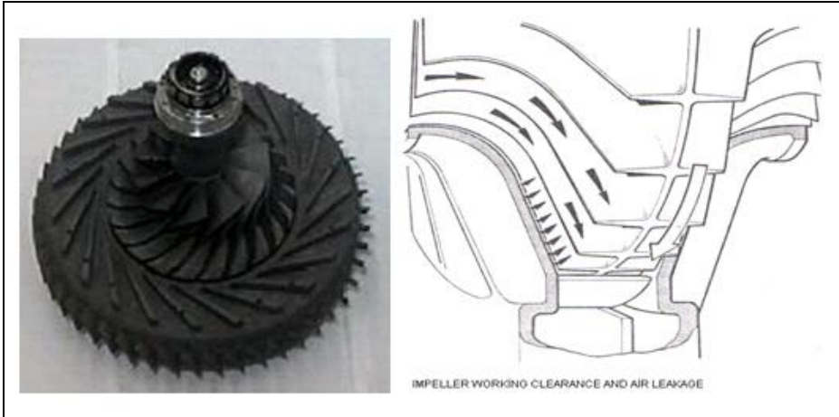
Resim 2.2: İmpeller ve impeller'da hava akışı
