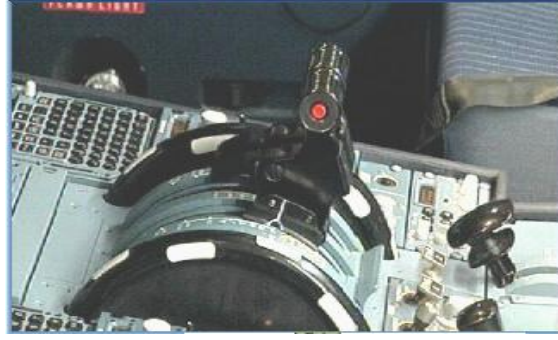
Resim 1.8. Elektrikli fwd thrust kumanda kolu
