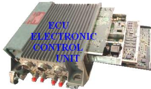
Resim 2.1: ECU ve içindeki elektronik devreler
