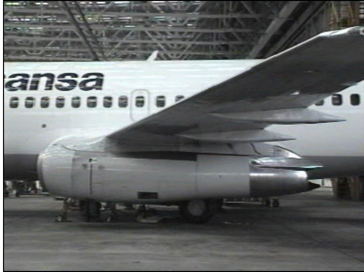
Resim 1.10: Motorun pylon’a bağlantısı
