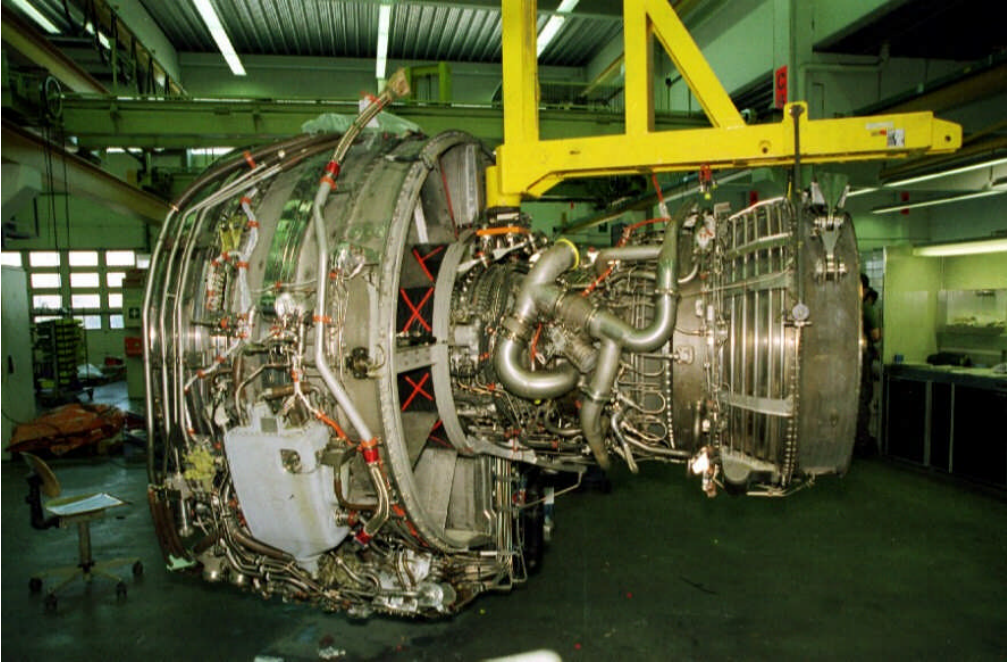
Resim 1.12: Aft mount bağlantı yerleri
