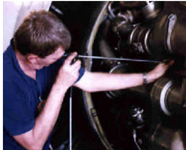
Resim 3.6: Borecope (boroskop) ile uçak motorunun kontrolü
