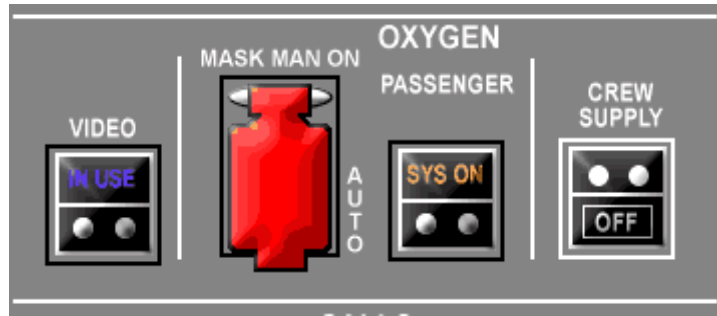
Şekil 3.1: Yolcu servis ünitesi (Passenger Service Unit-PSU) kontrol paneli
