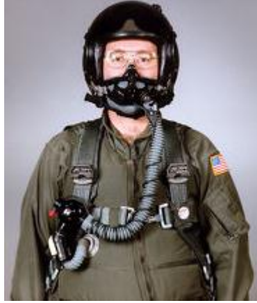
Resim 1.1: Askeri savaş uçaklarında kullanılan oksijen maske ve bağlantıları
