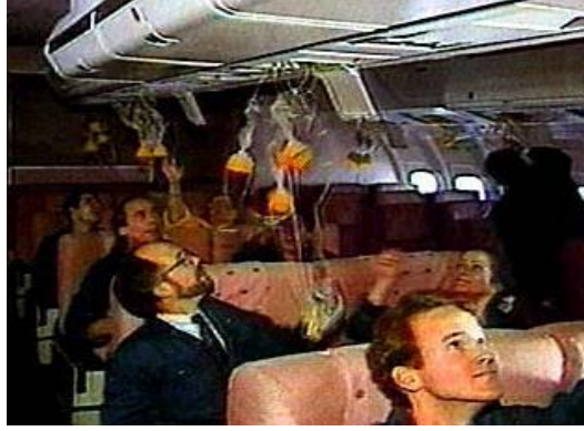
Resim3.4: Yolcu oksijen sistemleri oksijen maskelerinin açılması
