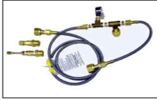
Resim2.7: Uçuş ekibi oksijen sistemi tüp doldurma bağlantısı
