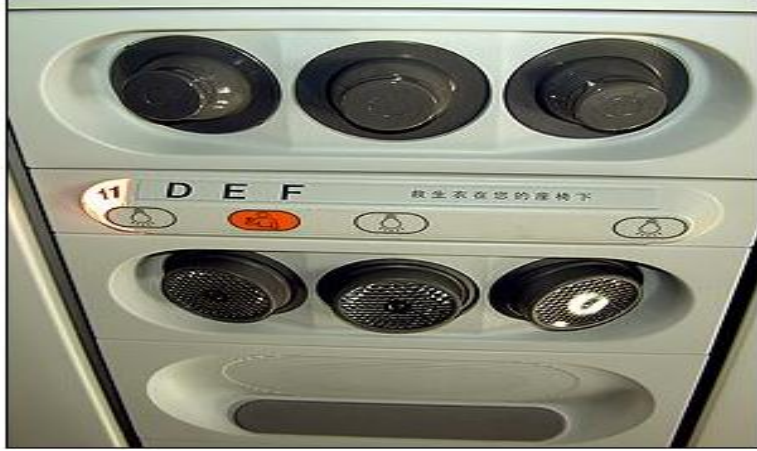
Resim 3.1 : Yolcu servis ünitesi (Passenger Service Unit-PSU) yerleri
