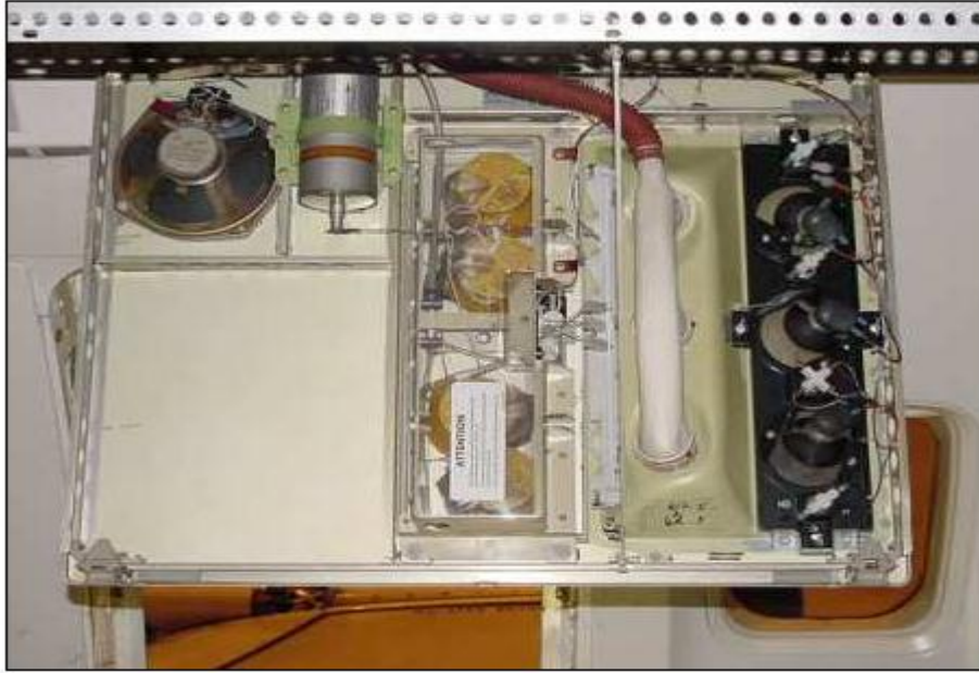
Resim 3.2:Yolcu servis ünitesinin (Passenger Service Unit-PSU) açılmış hali
