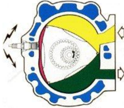
Şekil 1.73: Wankel motorun çalışma prensibi
