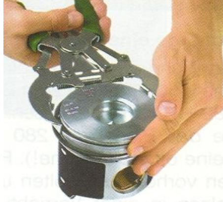
Şekil 1.23: Segman pensesi ile segmanın pistondan çıkarılışı
