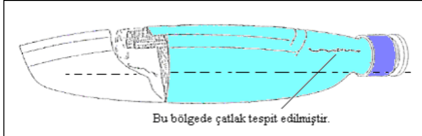
Şekil 4.6: Palde çatlak tespiti
