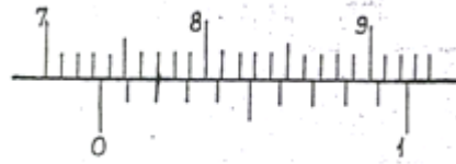
Şekil 2.6: Okunan ölçü: 73,2 mm
