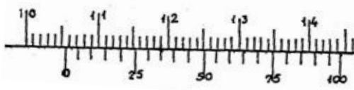
Şekil 2.9: Okunan ölçü: 105,35 mm
