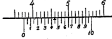
Şekil 2.8 : Okunan ölçü 37,45 mm
