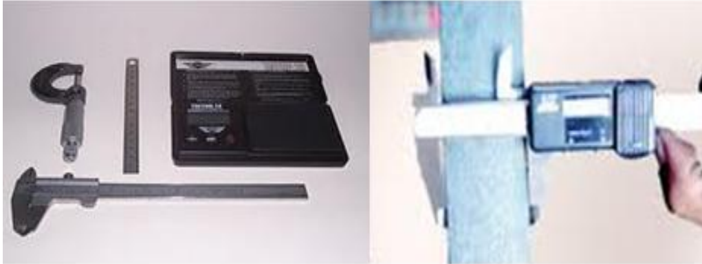
Resim 9.3: Çeşitli ölçü aletleri ve verniyerli kumpasın kullanımı
