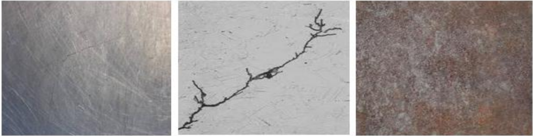
Resim 9.1: İş parçası üzerindeki çizikler, çatlak ve korozyon oluşumunun gözlemlenmesi
