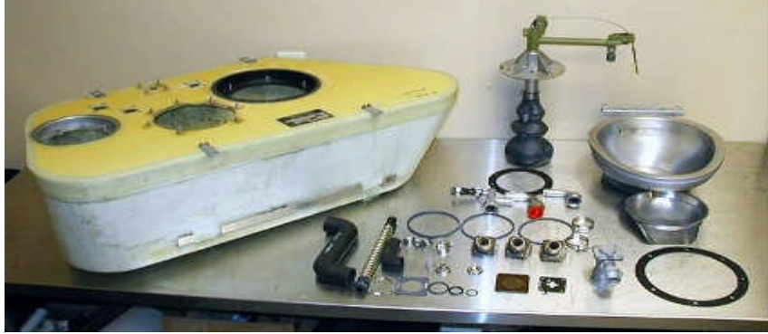
Resim 2. 3: Flush motorlu tip tuvalet sistemi tankı ve parçaları
