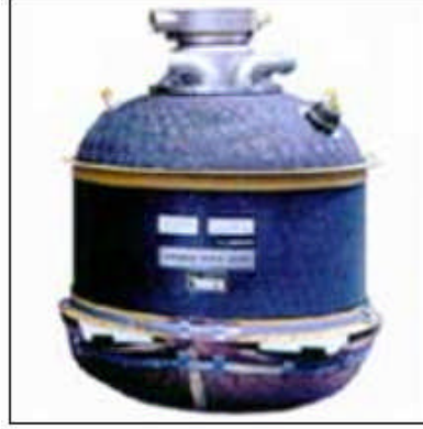
Resim 2.4: Airbus uçaklarında kullanılan vakumlu tip tuvalet sistemi tankı
