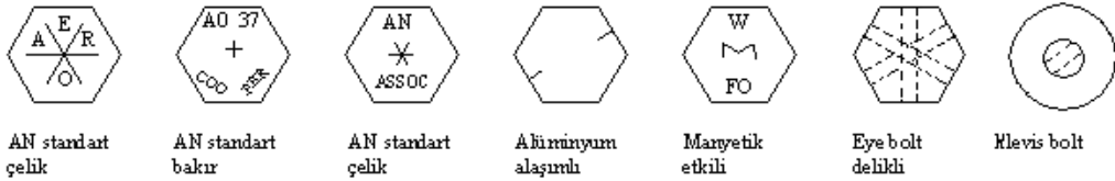
Şekil 1.2: Cıvata baş tipleri
