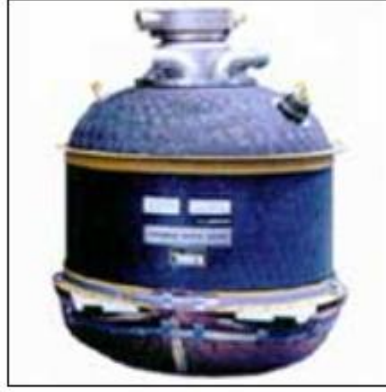
Şekil 2.9: Airbus uçaklarında kullanılan vakumlu tip tuvalet sistemi tankı
