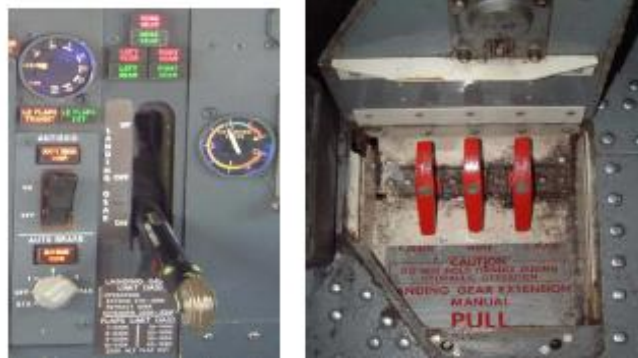
Resim 6.2: El ile açma mekanizması (solda) ve iniş takımı paneli (sağda)
