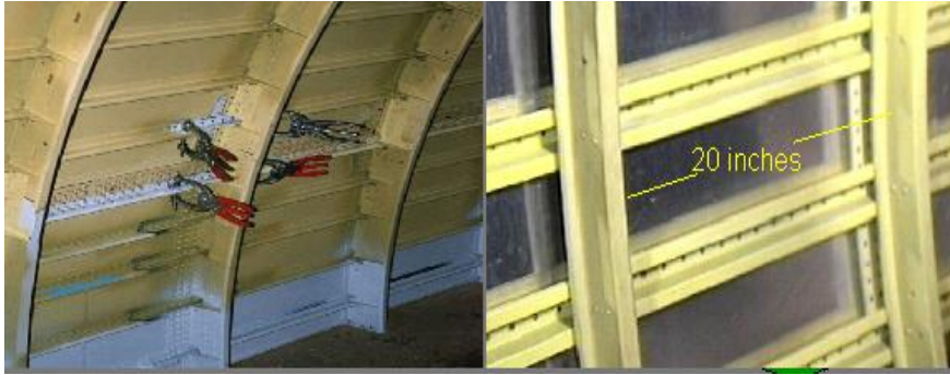
Resim 3.5: Resimde 7075 alaşımının kullanıldığı uçağın yapı elemanlarından stringer ve frame
