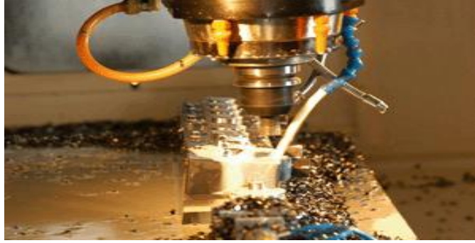
Resim 1.9: Motor bloku üzerinden talaş kaldırma işlemi
