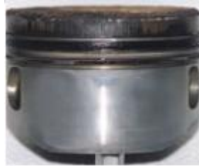
Resim 1.10: Korozyona uğramış piston
