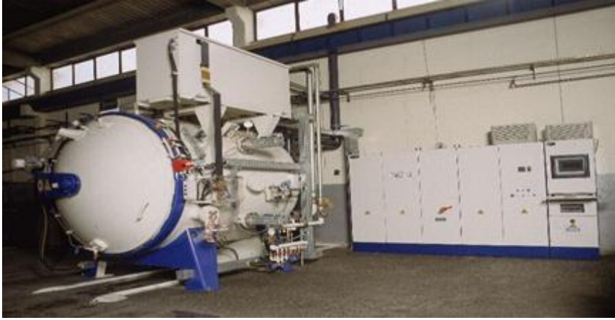
Resim 2.19: Tavlama işleminin yapıldığı vakum fırını
