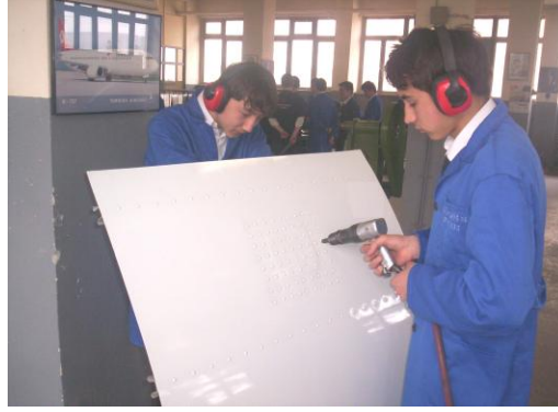
Şekil 2.1: Havalı perçin tabancası ile perçinleme
