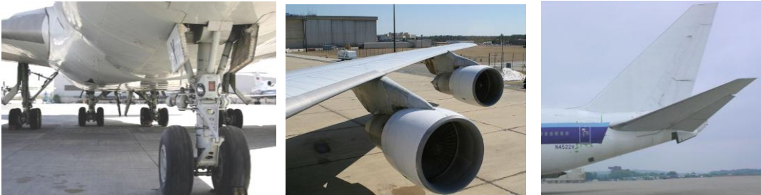
Resim 1.3: Lockbolt bağlayıcıların kullanım yerleri
