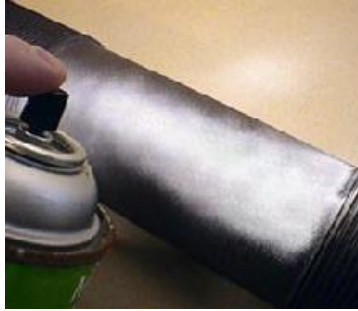
Resim 2.6: Penetrant boya uygulaması
