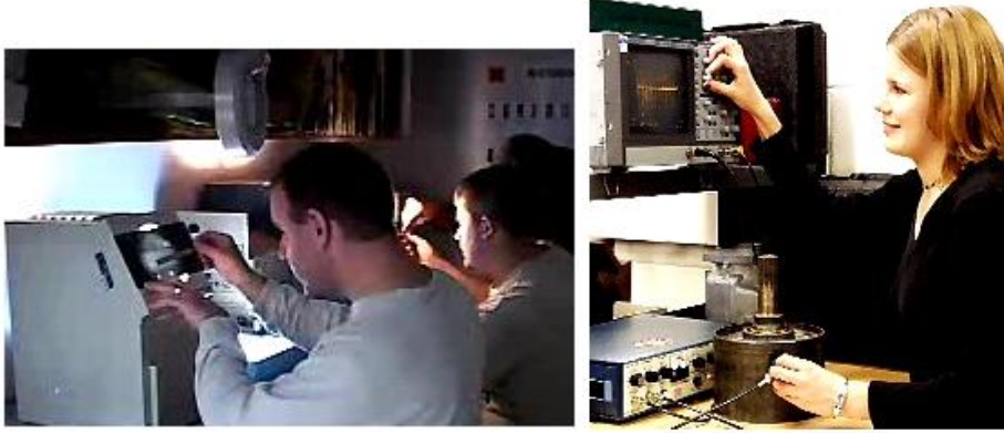
Resim 1.5: Hacimsel yöntemler (Radyografi ve ultrasonik kontrol)
