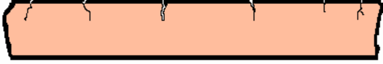
Şekil 1.1: Yüzeğe açık süreksizlik
