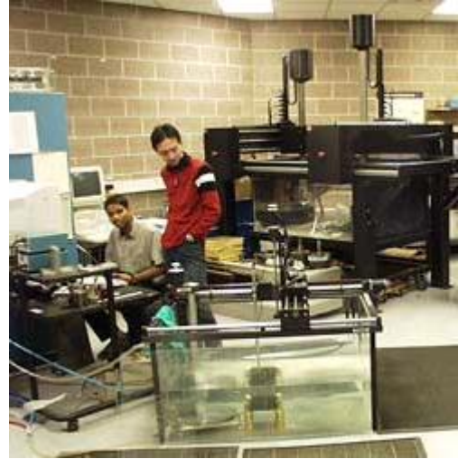
Resim 5.3: Daldırma yoluyla malzeme kontrolü
