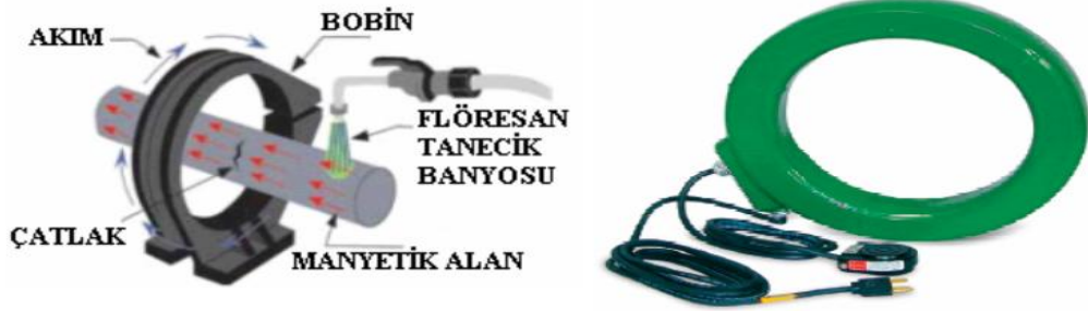
Resim 3.5: Bobin ile manyetizasyon işlemi
