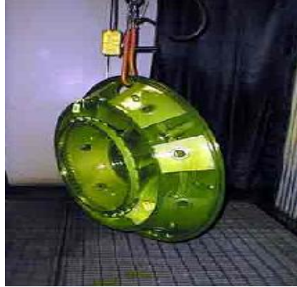
Resim 2.9: Malzemenin developer (geliştirici) uyguladıktan sonra kurutulması
