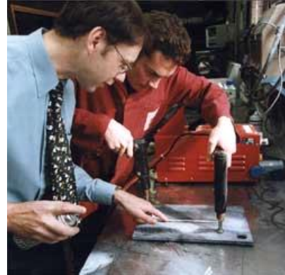
Resim 3.9: Manyetizasyon meydana getiren prodlar ve manyetizasyon işlemi
