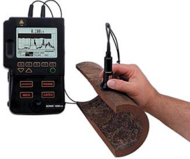
Resim 5.2: Ultrasonik test cihazı ile parça kalınlığının ölçümü
