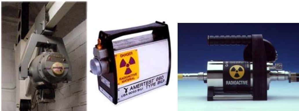
Resim 6.5: Uzaktan kumanda edilen gama ışın tüpü ve elde taşınabilen gama ışın tüpleri
