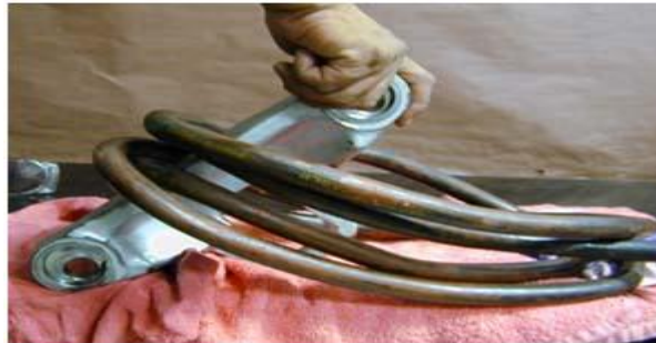
Resim 3.7: Bağlantılı bobin ile manyetizasyon
