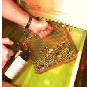
Resim 2.4: Penetrant boyanın yıkanması
