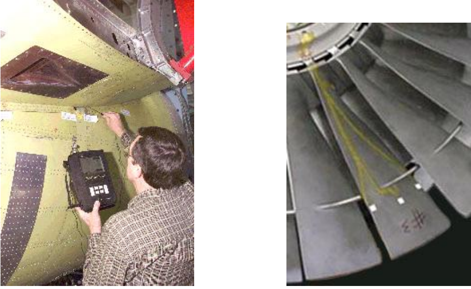
Resim 4.5: Uçak üzerinde eddy current uygulamaları
