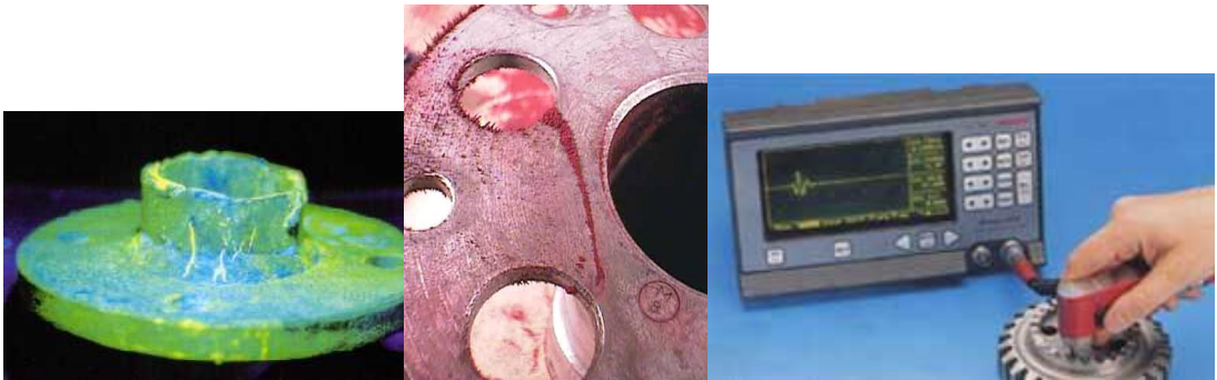
Resim 1.4: Yüzeğ yöntemleri penetrant (sıvı girinim), manyetik parçacık, eddy current (girdap akımları) kontrolü
