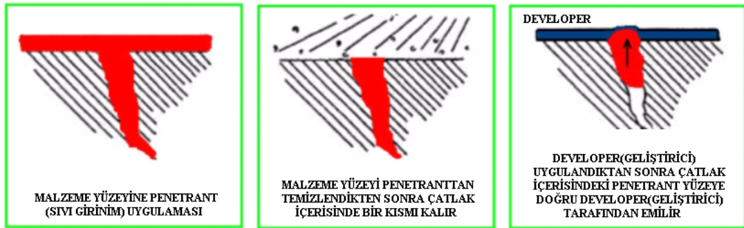
Şekil 2.1: Penetrant (sıvı girinim)kontrolünde penetrant boya uygulaması
