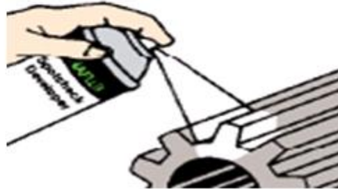
Resim 2.8: Malzeme üzerindeki penetrantın temizlenmesi ve developer (geliştirici) uygulaması
