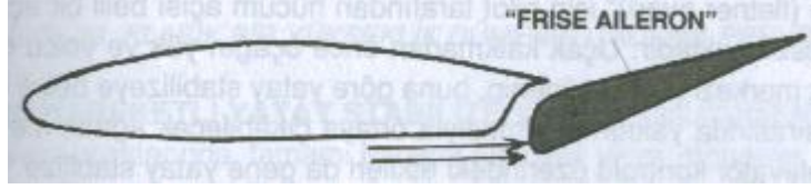
Şekil 1.4: Frise kanatçık yapısı
