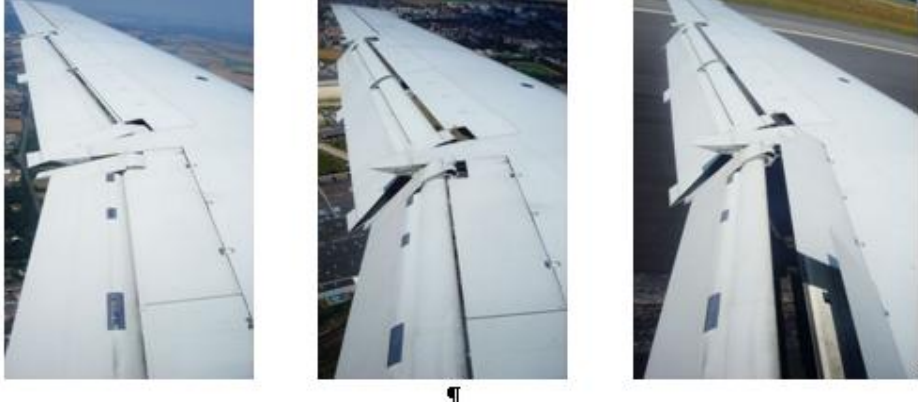
Resim 1.7: Flaplar tamamen kapalı, sadece flaplar açık, flaplar ve spoilerler birlikte açık durumları görülüyor.
