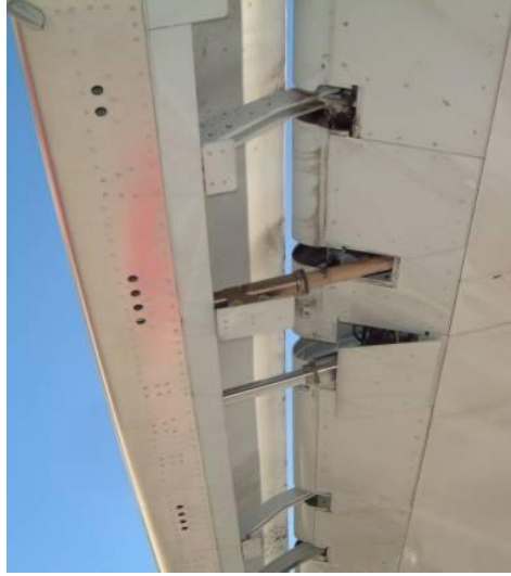
Resim 1.5: Bir yolcu uçağının açılmış haldeki slatlarının alttan görünüşü
