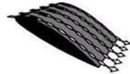
Girdaplı Hava Akımı Kanat Üzerinde Kalıyor.
