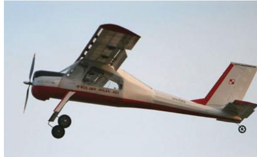
Resim 1.4: Slotlu uçaklardan PZL-104 Wilga planör römork uçağı
