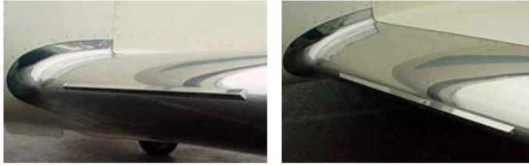
Resim 1.14: Kanat hücum kenarında stall strip görüntüsü
