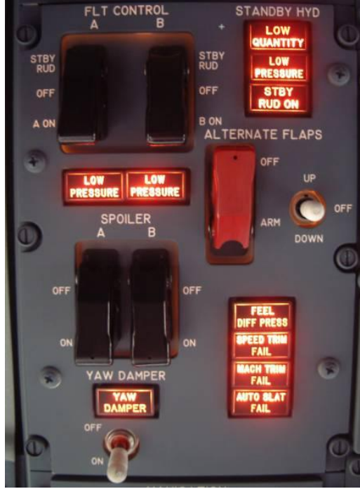
Şekil 3.2: Kokpitteki yaw damper-mach trim gösterge paneli
