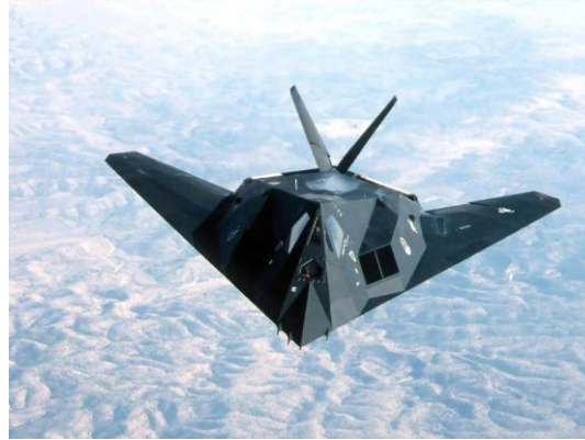
Resim 1.3: F-117 uçağının V şeklinde kuyruk yapısı-Ruddervator
