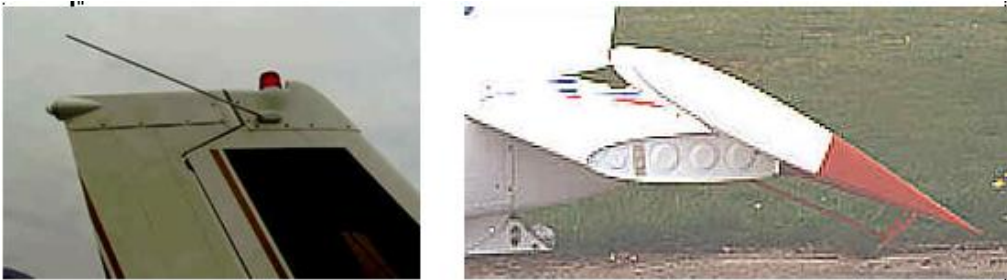
Resim 1.16: Rudder ve elevator'de kütle balans uygulamaları
