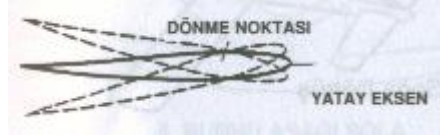
Şekil 1.7: Hareketli yatay stabilize ve elevatorun üstten ve yandan görünüşü
