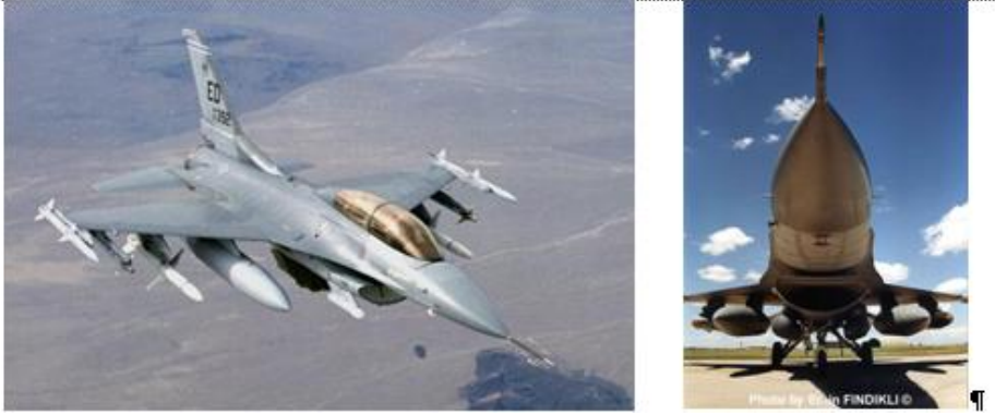
Resim 1.10: F-16’da kokpitin iki tarafında strake kısmının yandan ve alttan görüntüsü
