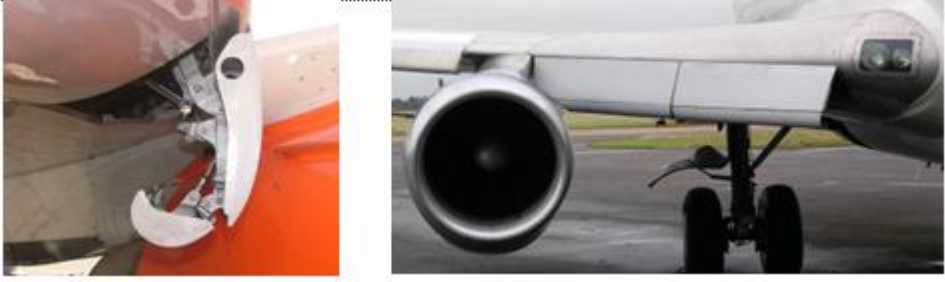
Resim 1.6: Kruger flap açılmış halde yandan ve önden görünüşü
