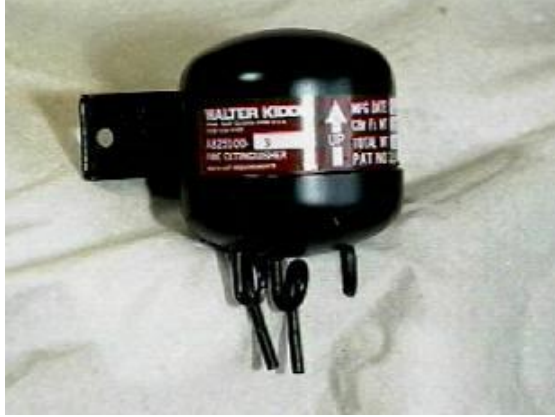
Resim 2.11: Lavabo yangın söndürme sistemi sıcaklık algılayıcı panel
