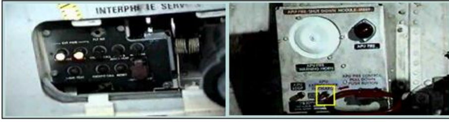
Resim 2.10: Harici elektrik kaynağı bağlantı paneli ve ana iniş takım yuvası APU FIRE kontrol panelleri
