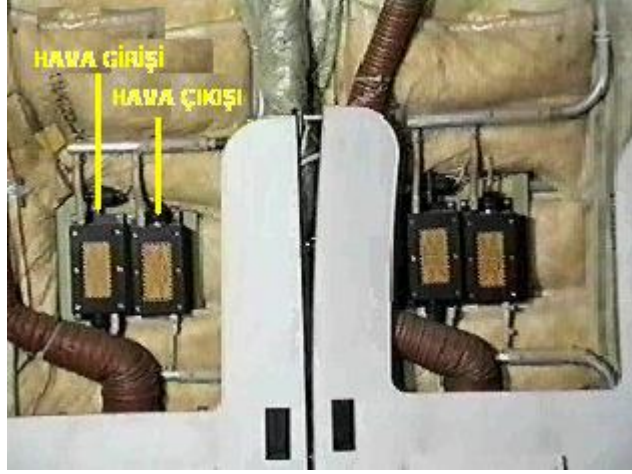
Resim 1.7: Kargo kompartmanlarında kullanılan kanal tipi duman dedektörü
