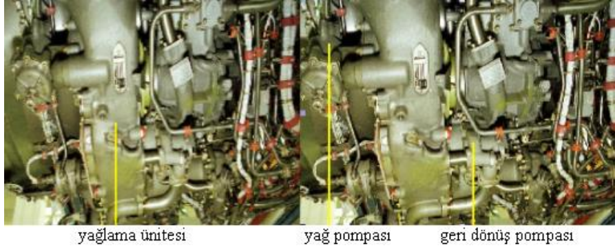
Resim 2.4: Yağ pompası ve geri dönüş pompasının uçtaki yerleri
