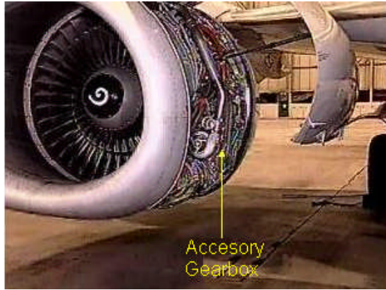
Resim 3.3: Aksesuar dişli kutusunun uçak motorundaki yeri
